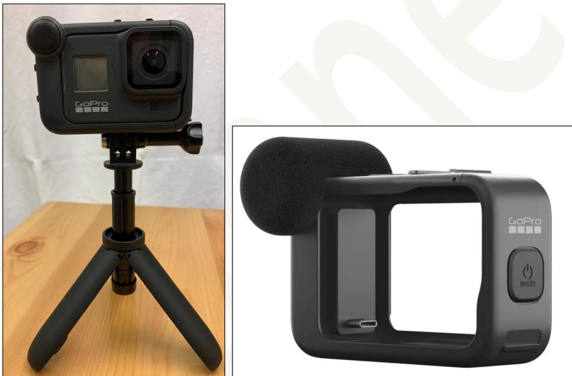
Abbildung 10: Links: GoPro HERO8 im Creator-Kit-Rahmen, montiert auf einem GoPro-eigenen Standfuß. Rechts: Der Creator-Kit-Rahmen mit HDMI-Anschluss, in den die GoPro HERO12 hineingesteckt wird. Bildquellen: [www.hahner.de](http://www.hahner.de), [www.gopro.com](http://www.gopro.com)
