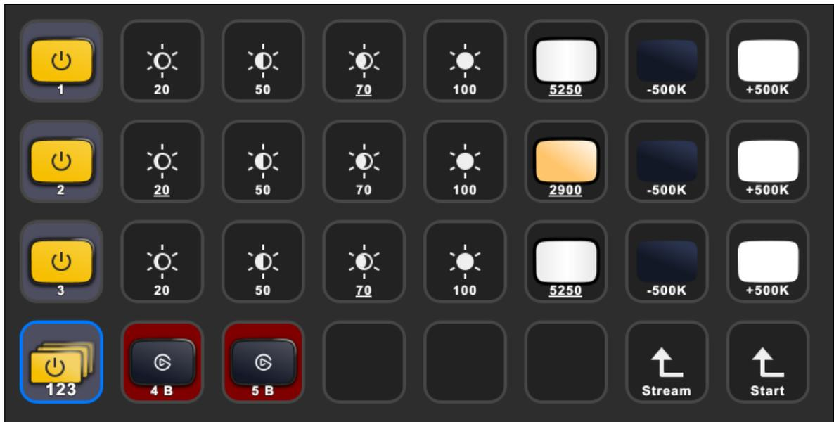
Abbildung 22: Beim Einsatz eines STREAM DECKS lassen sich die KEY LIGHT-Module komfortabel über einen einfachen Tastendruck steuern. Bildquelle: [www.hahner.de](http://www.hahner.de)
