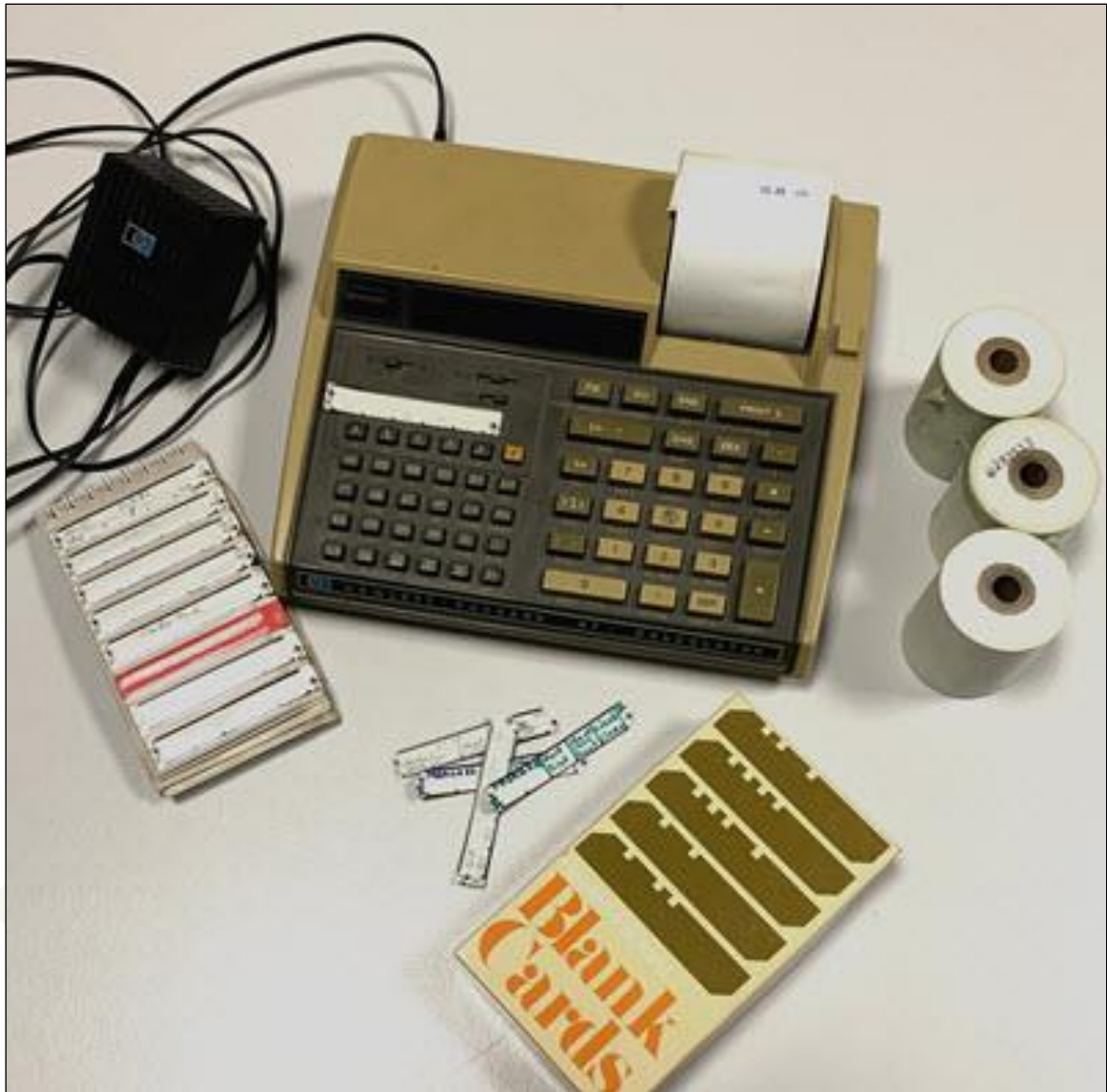
Abbildung 17 Hahners Adventskalender 2019 Türchen 17: HP-97 Taschenrechner mit Drucker und Magnetstreifen
